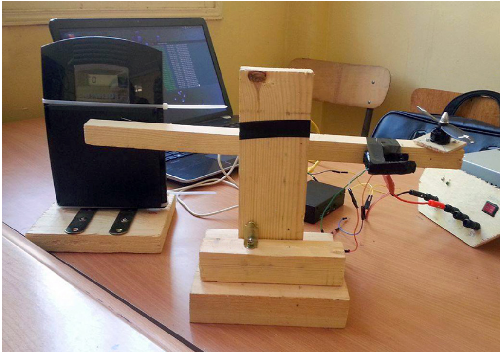
FIGURE 4.24: Montage réalisé pour l'identification du moment de trainée
