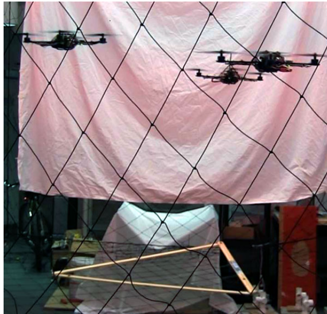
FIGURE 1.3: Coopération de trois quadrirotors pour le soulèvement d'une charge
