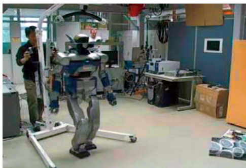
FIGURE 2.3: Robot HRP-2 qui marche d'une manière autonome en utilisant MonoSLAM
