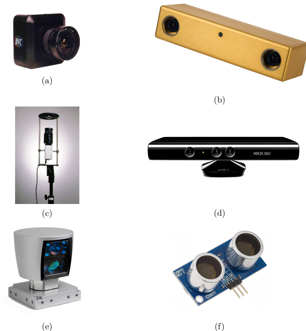
FIGURE 2.2: Exemples de capteurs utilisés pour le SLAM (a) caméra monoculaire, (b) caméra stéréo, (c) caméra omnidirectionnelle, (d) caméra RGB-D, (e) télémètre laser, (f) télémètre sonar
