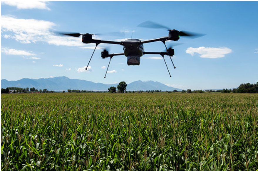
FIGURE 1.6: Quadrirotor Indago utilisé pour la surveillance de l'état des cultures
