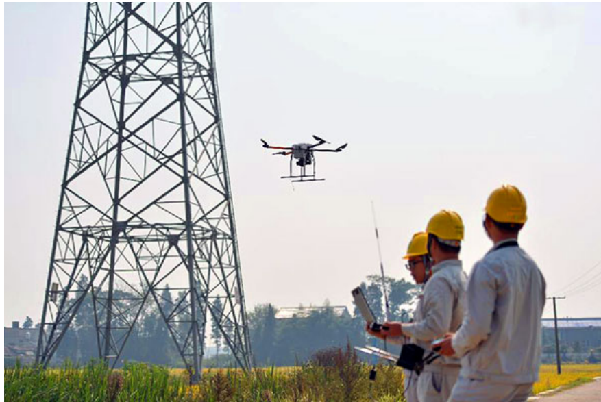
FIGURE 1.7: Quadrirotor équipé d'une caméra infrarouge pour la surveillance des lignes à très haute tension (UHT)
