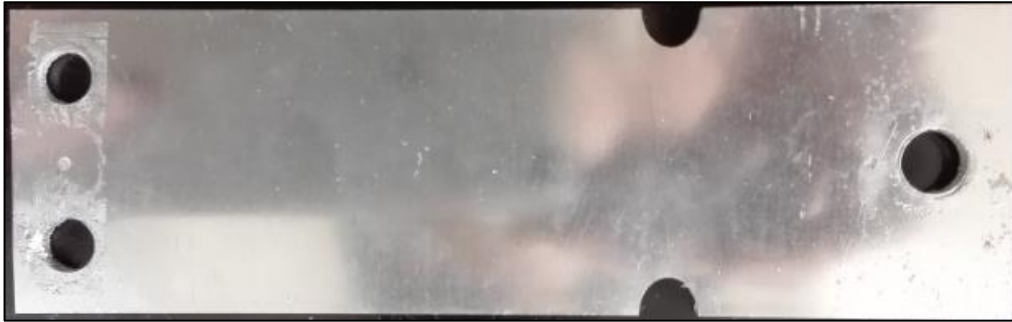
Figure IV. 15: Eprouvette à entailles elliptiques.
