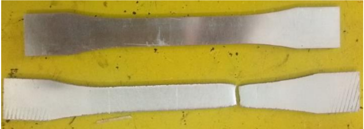
Figure III. 16: Éprouvette rompue après l'essai de traction.
