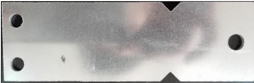
Figure IV. 16: Eprouvette à entailles en « V ».
