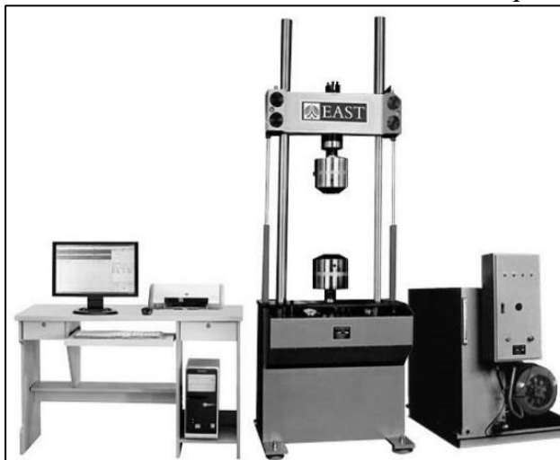
Figure III. 3: Machine d'essais universelle. [1]
