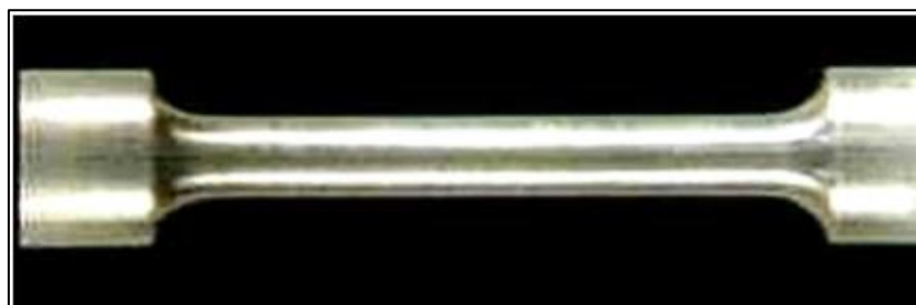
Figure III. 7: Eprouvette pour flexion rotative.
