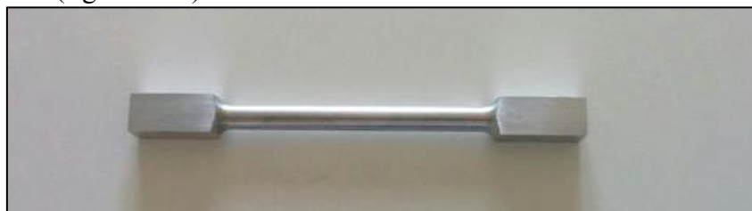
Figure III. 4: Eprouvette d'essai de torsion.
