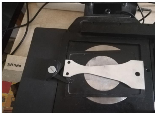
Figure III. 21: Orientation de l'éprouvette face à la lunette.
