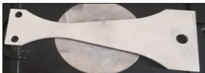
Figure III. 6: Eprouvette d'égale résistance.
