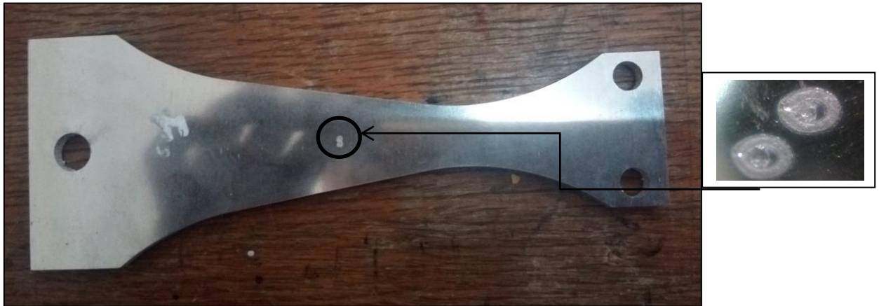
Figure III. 19: Epreuves d'égal résistance pour les essais en flexion plane avec deux piqures.
