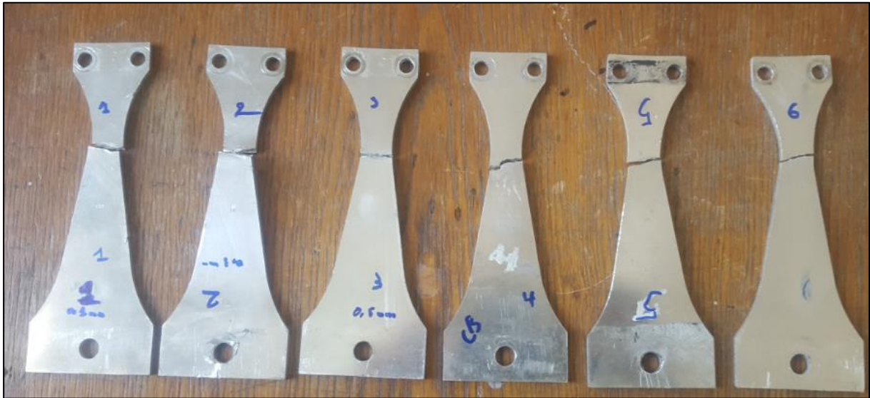
Figure IV. 1 : Zone de rupture des éprouvettes.
