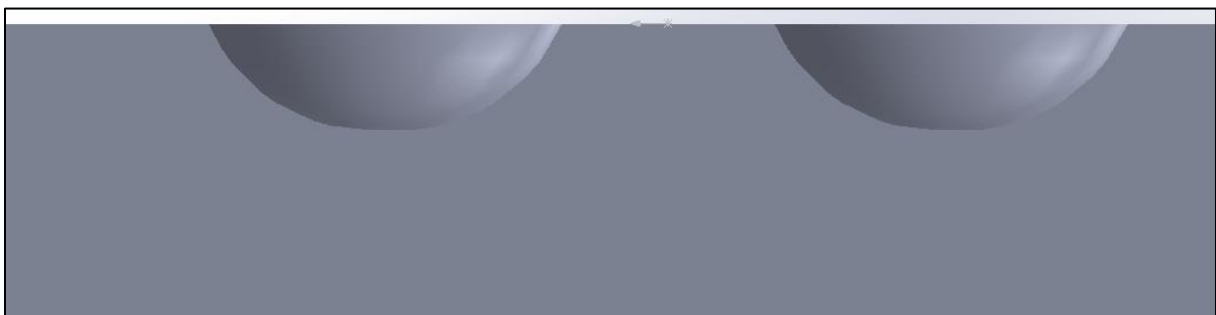
Figure II. 14: Caractéristiques des piques (profondeur : 0.3 mm, diamètre : 1 mm)
