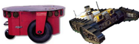
Figure 1.3: Exemple de plate-forme différentielle. Pioneer 2 DX de la société MobileRobots et Urban Robot de la société iRobot.
