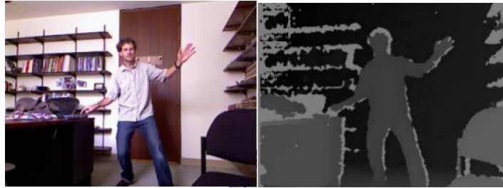
Figure 2.15: Acquisition d'une image de profondeur avec la Kinect.
