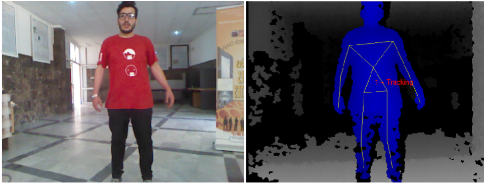
Figure 4.26: A gauche image couleur (RGB), à droite silhouette et squelette de la personne dans l'image de profondeur, à un instant t_3 .
