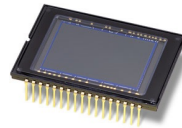
Figure K.4: Exemple d'un capteur photographique de type CMOS.
