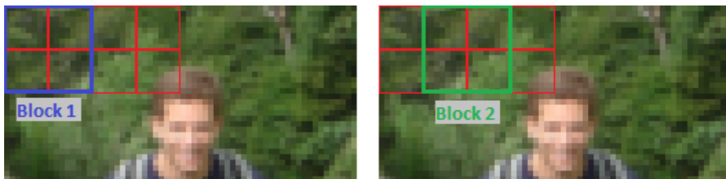
Figure 2.7: Le chevauchement des blocs choisi par Dalal et Triggs [15]
