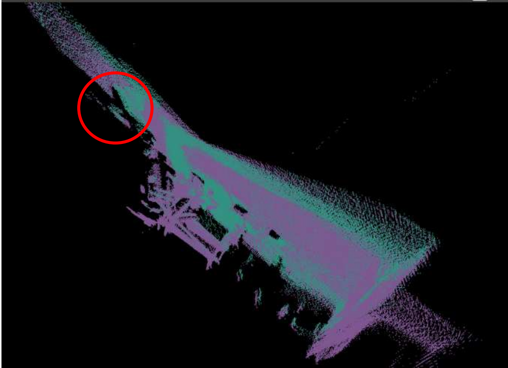
Figure 4-7: Recollage fait par RANSAC+ICP
