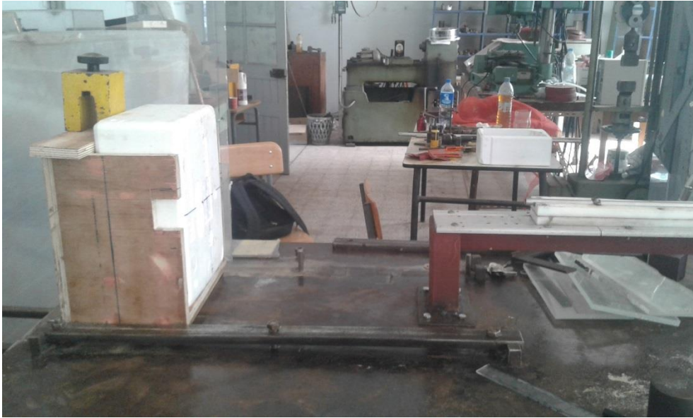
Figure 3.9 Récupérateur de projectile à 600 mm de la sortie de canon
