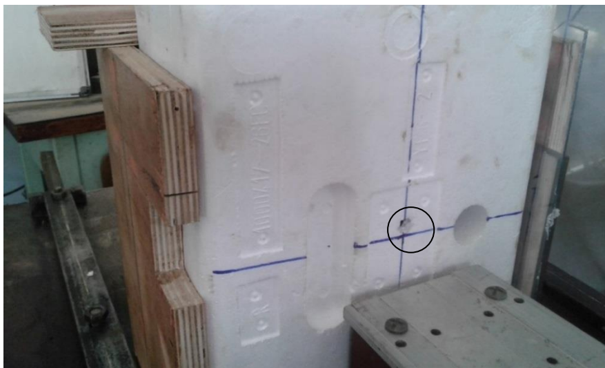
Figure 3.6 Position de pénétration à 200 mm de la sortie de canon
