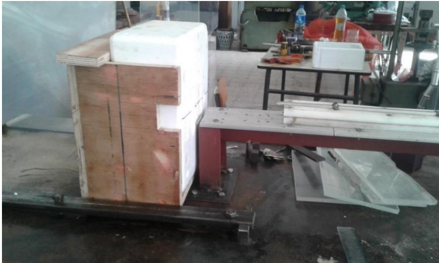
Figure 3.5 Récupérateur de projectile à 200 mm de la sortie de canon
