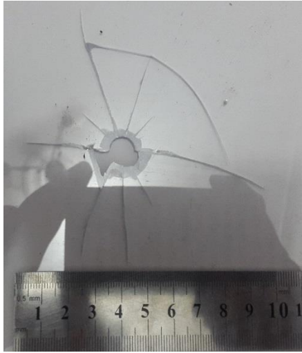
Figure 3.11 Epreuve endommagée 1 pour 1.5 bar et 0°
