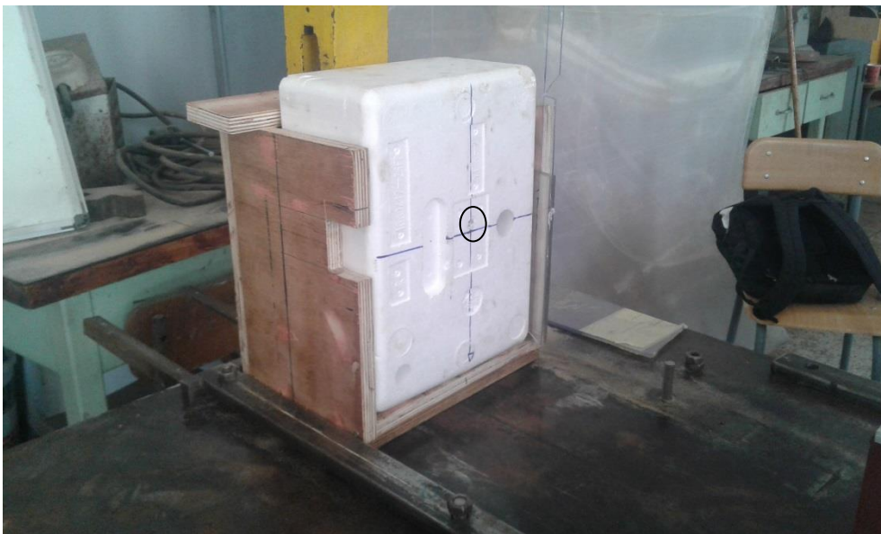
Figure 3.10 Position de pénétration à 600 mm de la sortie de canon
