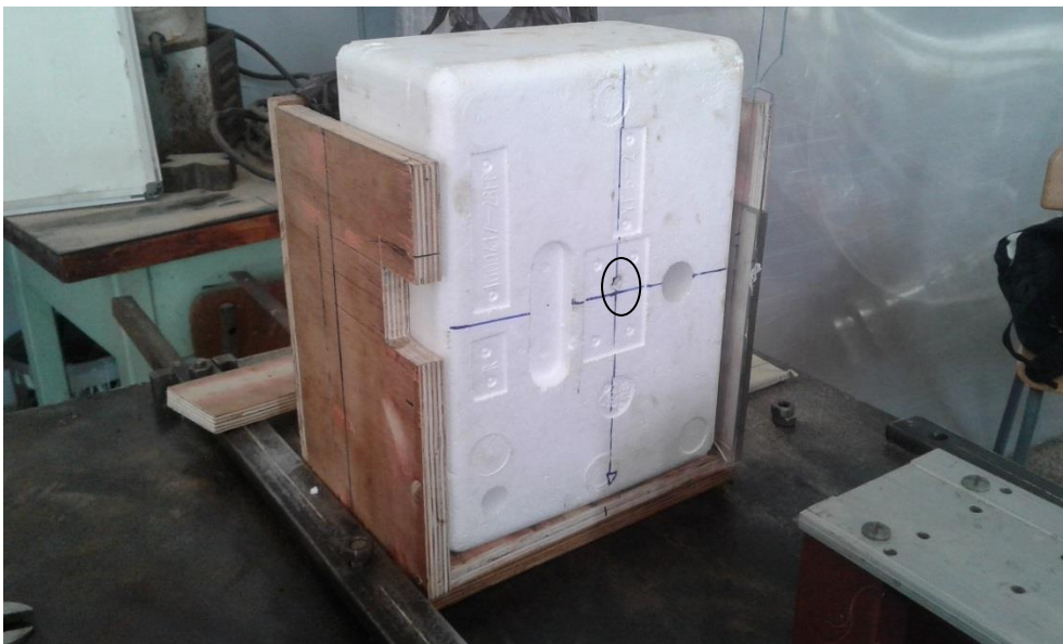
Figure 3.8 Position de pénétration à 400 mm de la sortie de canon
