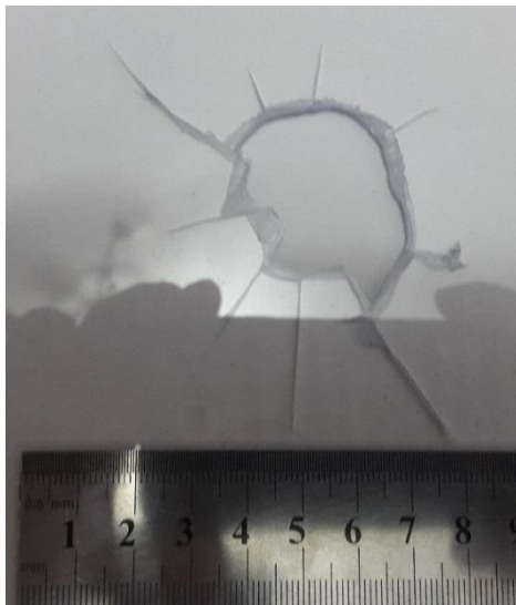
Figure 3.12 Epreuve endommagée 1 pour 2 bar et 0°
