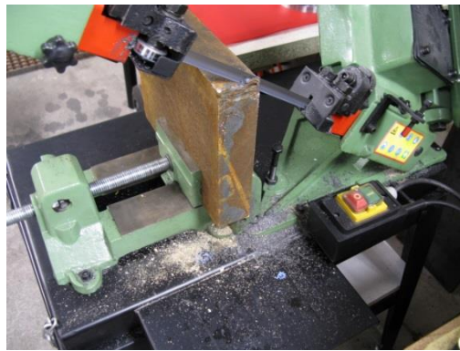
Figure 2.12 Scie à métaux mécanique.
