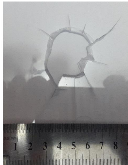
Figure 3.12 Epreuve endommagée 1 pour 2 bar et 0°
