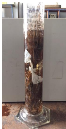
Figure 3.4 : Traitement des fibres avec une solution alcaline NaOH.
