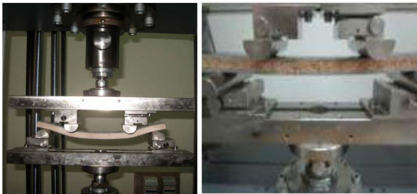
Figure 4.3 : Montage de l'échantillon sur la machine d'essais de flexion quatre points.
