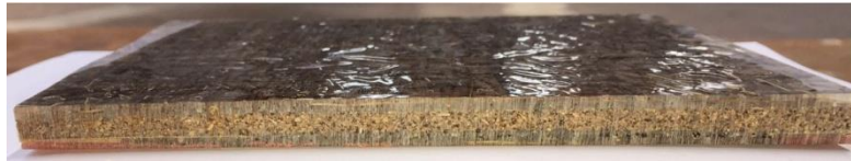
Figure 3.22 : Panneau sandwich élaboré avec les peaux stratifiées en fibre de palmier dattier et âme en mousse en kornav.
