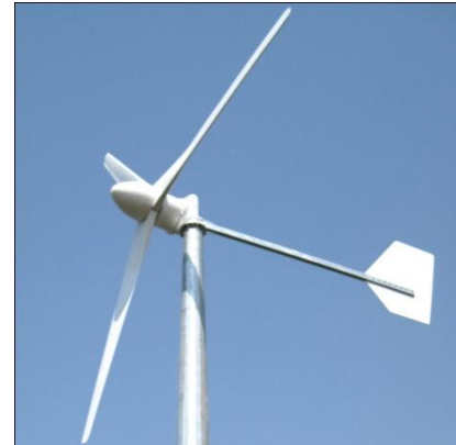
Fig. I.3 Eoliennes à axe horizontal.
