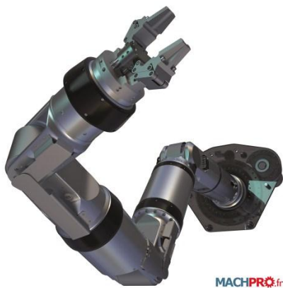
Figure 1.2 : Manipulateur sériel MOOG pour le nucléaire [INT 1]
