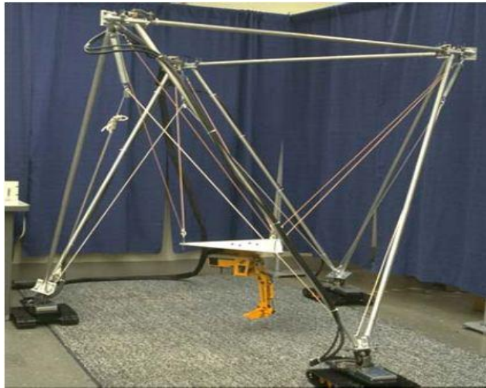
Figure 1.4: Manipulateur NIST Robocrane, un des premiers robots suspendus entraîné par câbles [2]
