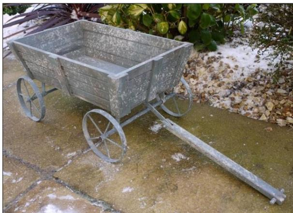
**Figure 1.2** – Chariot à 4 roues dirigé par un timon [2].
