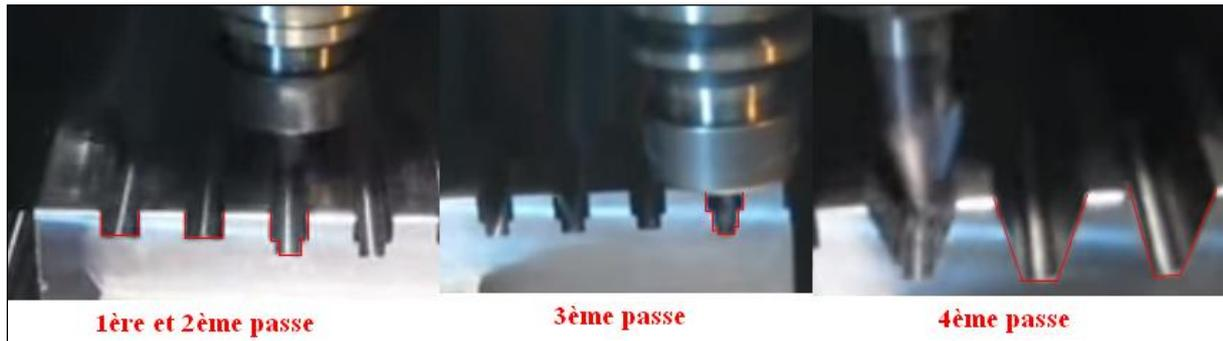
Figure 3.2 – Taillage sur une fraiseuse à commande numérique.
