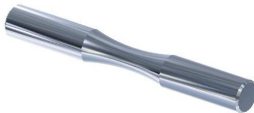
*Figure 2.1 Eprouvette toroïdale de fatigue [12]*
