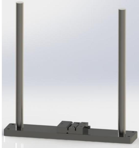
*Figure 3.20 La base de la machine, avec l'étau et les barres dessus*
