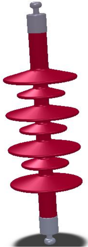
Figure. IV.10. Modèle 3D de l'isolateur 33kV
