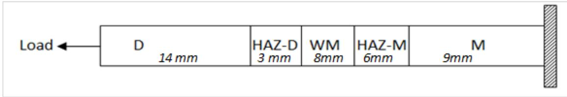
Figure 5.16. Représentation schématique du joint soudé hétérogène soumis à une traction (les distances ont été évaluées à partir de la macrographie et les profils de microdureté).
