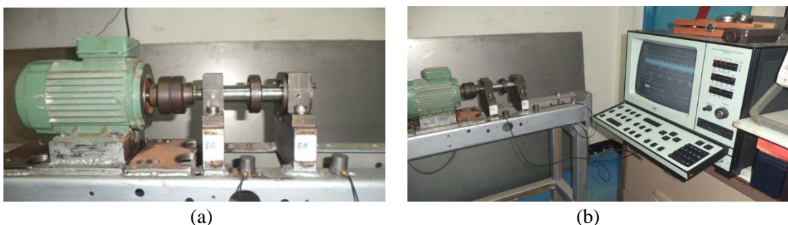
Fig. 6.8 (a) Photo du banc d'essais avec deux capteurs d'acquisition (b) Banc d'essais et Analyseur double canal (B&K 2133)
