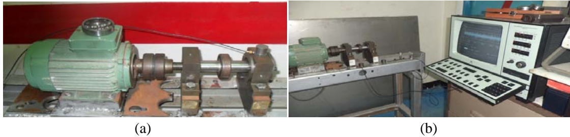
Fig. 5.10 (a) Photographie du banc d'essais, (b) Banc d'essais et Analyseur double canal (B&K 2133)
