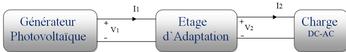
Figure 2.12 – Connexion d'un GPV à une charge à travers un étage d'adaptation.
