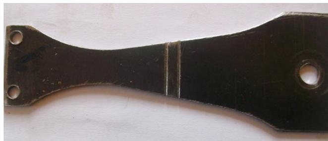
Figure .2.15 : Éprouvette entaillée utilisée à section droite rectangulaire et à profil triangulaire d'égale résistance
