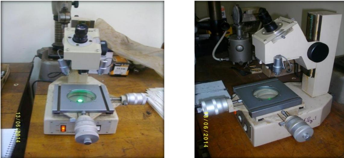
Fig.3.7. Microscope pour vérifier les entailles
