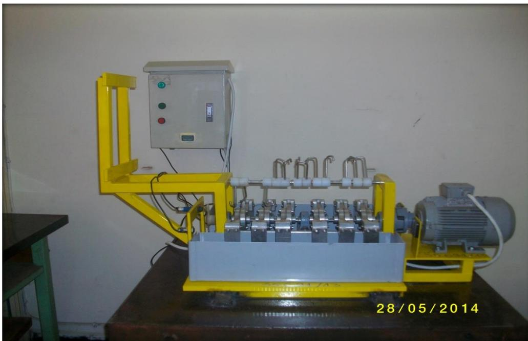
Fig.2.3.la machine de fatigue en flexion plane
