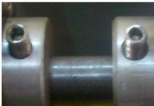
**Fig.2.10. vis de pression**
