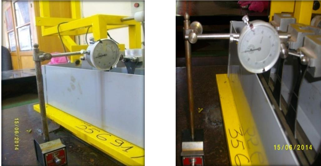
Fig. .3.4. Vérification de l'excentricité avec un comparateur
