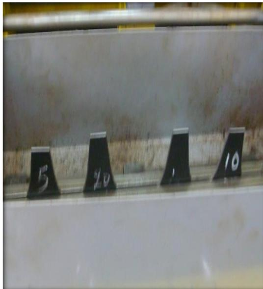
Fig.3.9. A Partie d'éprouvettes après la rupture fixées sur le bâti
