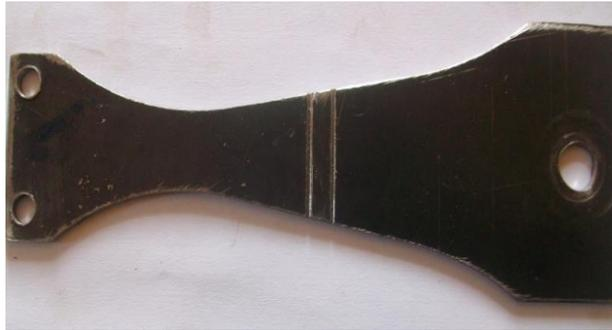
**Fig. 1.15 Éprouvette entaillée utilisée à section droite rectangulaire et à profil triangulaire d'égale résistance**
