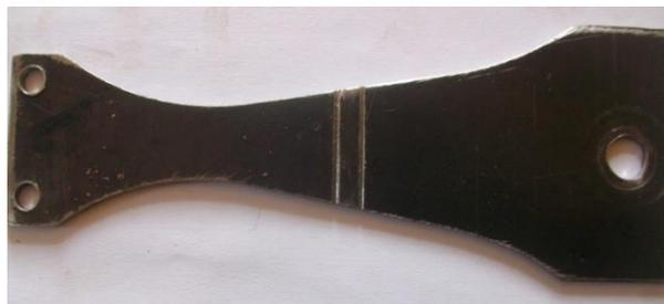
Fig. 3.2.Éprouvette entaillée
