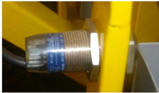
**Fig.2.9. capteur de mouvement pour l'arrêt automatique**
