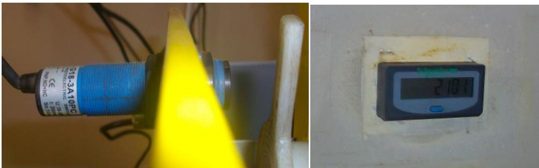
**Fig.2.12. Capteur et écran LCD affichant nombre des cycles**
