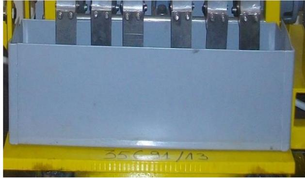
**Fig.2.8. Cellule de corrosion**
