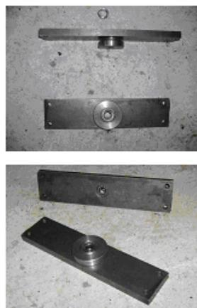
**Fig. II.18.** *Les roulements à billes montés sur les plaques rectangulaires*
