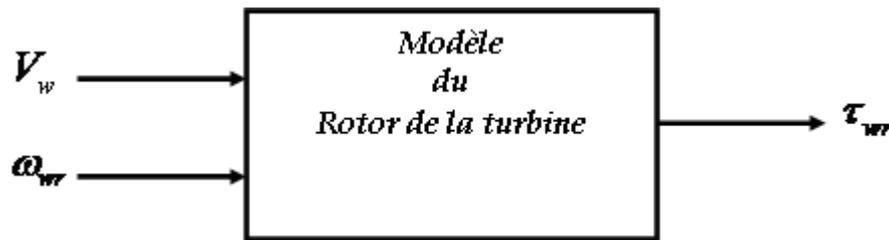
Fig. II.5. Schéma en bloc du sous système « Rotor de Savonius »
