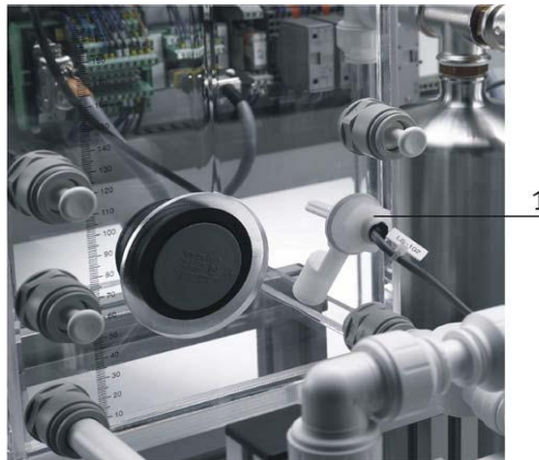
Figure 3.8: Flotteur pour la détection des seuils de remplissage.
