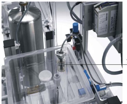
Figure 3.7: Flotteur de sécurité anti débordement.
