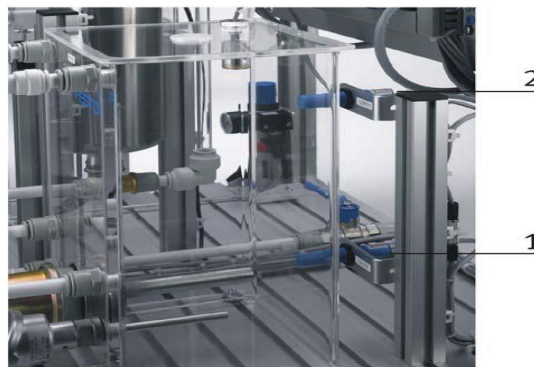
Figure 3.6 : Détecteurs de proximité capacitifs.
