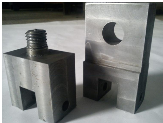
Fig. V.10 dispositifs de fixation de l'éprouvette :
