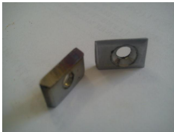
Fig. V.4 mécanismes pour la fixation de l'extensomètre
