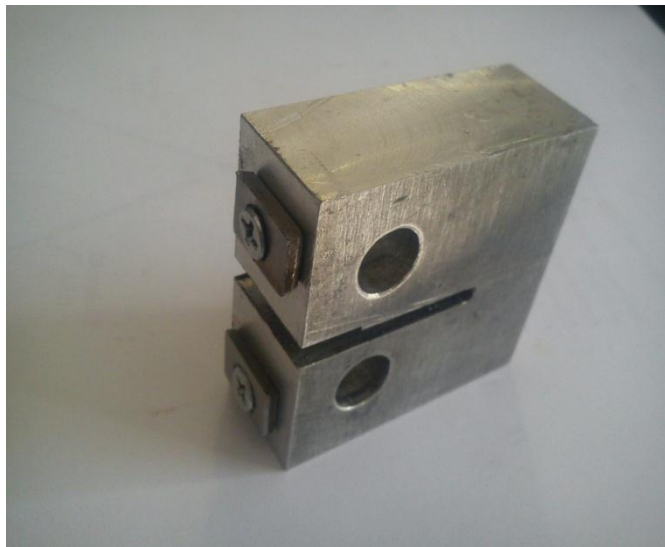
Fig. V.5 éprouvette CT préparée
