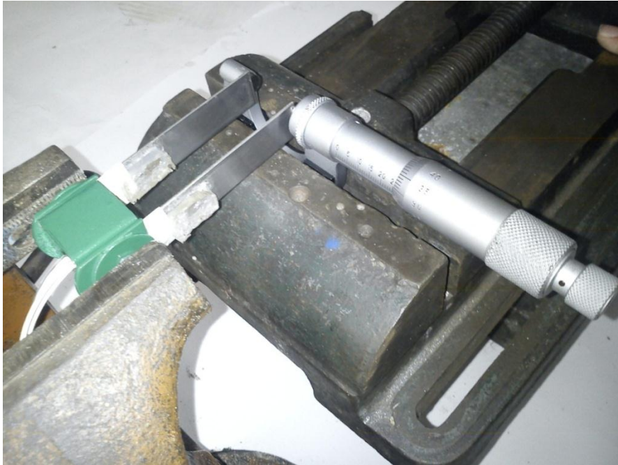
Fig. V.6 schéma d'étalonnage du l'extensomètre.
