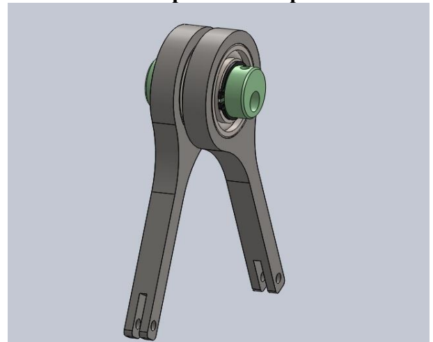
4- Monter deux bielles sur chaque maneton.
