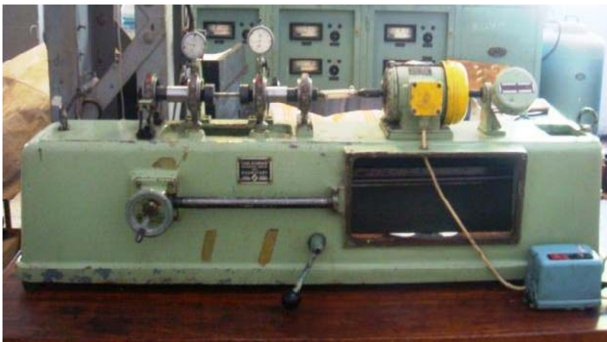
PHOTO III-2- : Machine de flexion rotative « SCHENCK »
