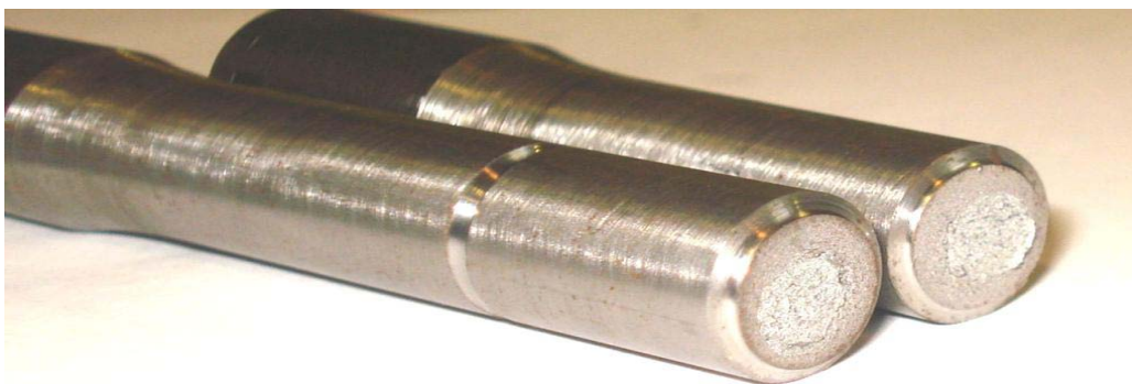
Photo IV-1-: Rupture de l'éprouvette pour X = 20 mm
