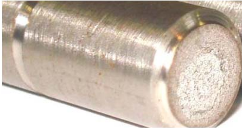
Photo IV3: Rupture de l'éprouvette pour X = 30 mm
