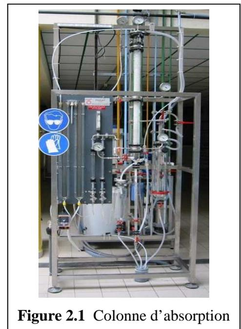
**Figure 2.1** Colonne d'absorption
