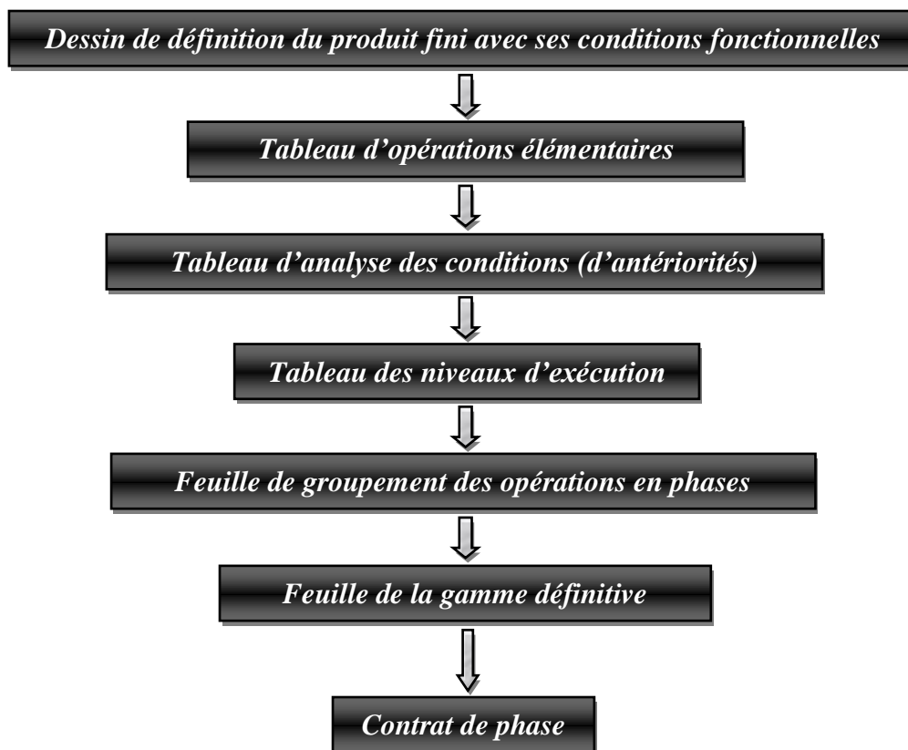
Figure III.1 : Schéma directeur de la méthode développée de traitement de gammes d'usinage.
