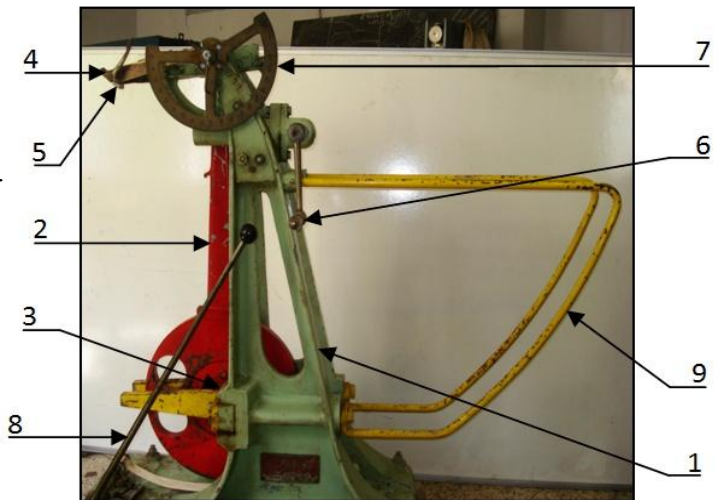
Fig. II.1 Composants de mouton-pendule
