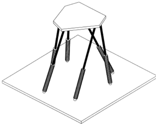
(a) Plateforme avec vérins
