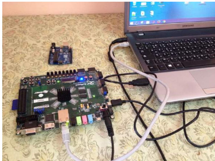
FIGURE 4.27: Branchement sur Zedboard
