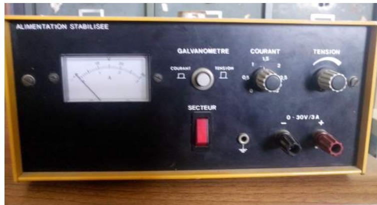
FIGURE A.8: Alimentation stabilisée
