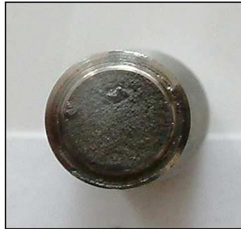
Photo.IV.8 : Faciès de rupture de l'éprouvette X = 20 mm sans traitement thermique
