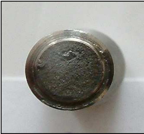
Photo.IV.3 : Faciès de rupture de l'éprouvette X=20 mm
