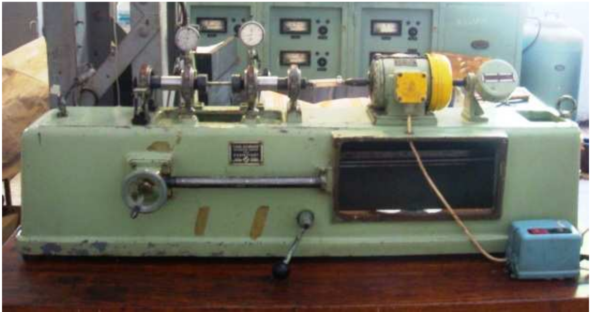
Photo.III.1 : Machine de flexion rotative « SCHENCK »
