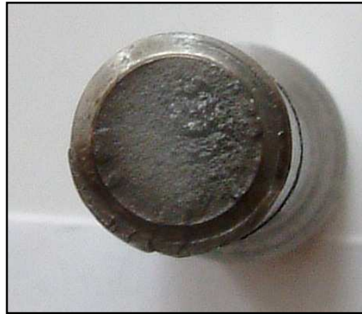
Photo.IV.4 : Faciès de rupture de l'éprouvette X = 15 mm
