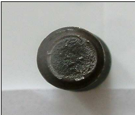
Photo.IV.7 : Faciès de rupture de l'éprouvette X=20 mm avec traitement thermique
