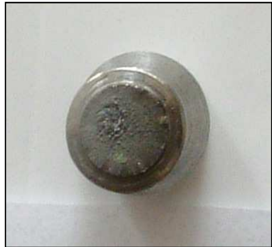
Photo.IV.2 : Faciès de rupture de l'éprouvette X = 10 mm
