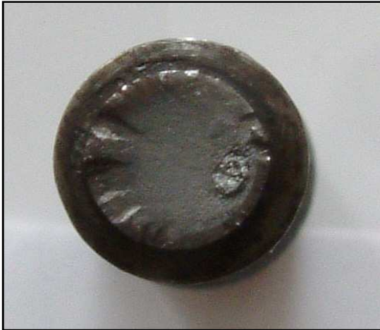
Photo.IV.5 : Faciès de rupture de l'éprouvette X=10 mm avec traitement thermique
