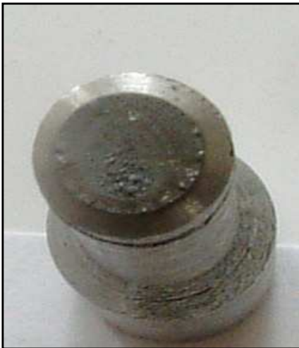
Photo.IV.1 : Faciès de rupture de l'éprouvette X=5 mm
