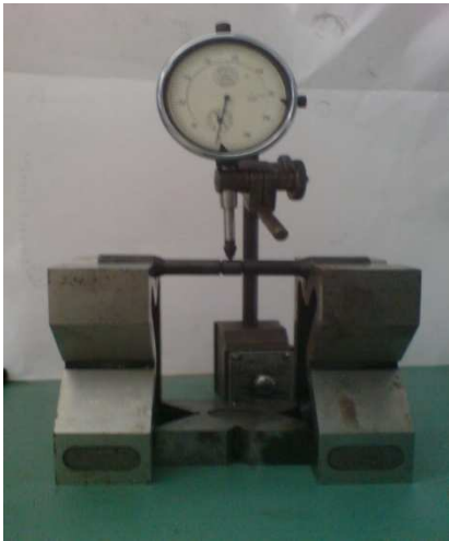
Photo.IV.9 Vérification de l'excentricité
