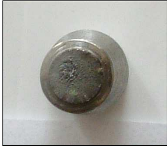
Photo.IV.6 : Faciès de rupture de l'éprouvette X = 10 mm sans traitement thermique
