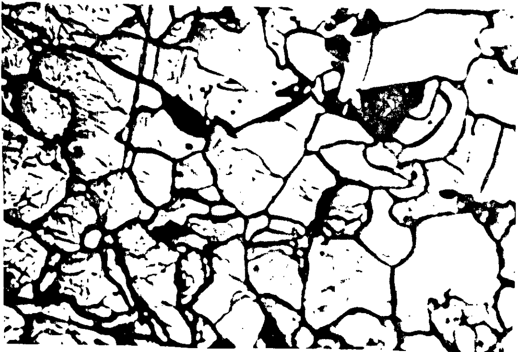
Fig 6-8: Micrographie optique montrant un réseau très dense de nitrures (X200) d'un alliage binaire Fe-Cr à 5% nitruré 35h à 510°C, attaqué au Nital 2%
