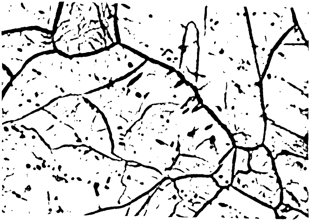
Fig 6-7: Micrographie optique montrant un réseau dense de nitrures (X500) d'un alliage binaire Fe-Cr à 2% nitruré 35h à 510°C, attaqué au Nital 2%
