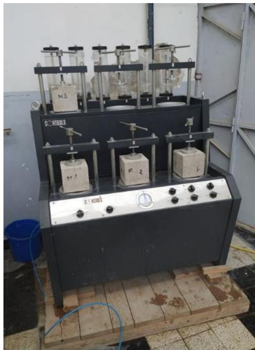
Figure 3.14 : Dispositif d'Essai de perméabilité à l'eau
