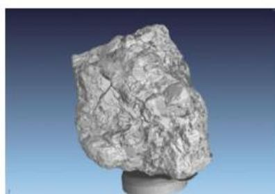
Granulat de béton recyclé (GBR) en 3D
