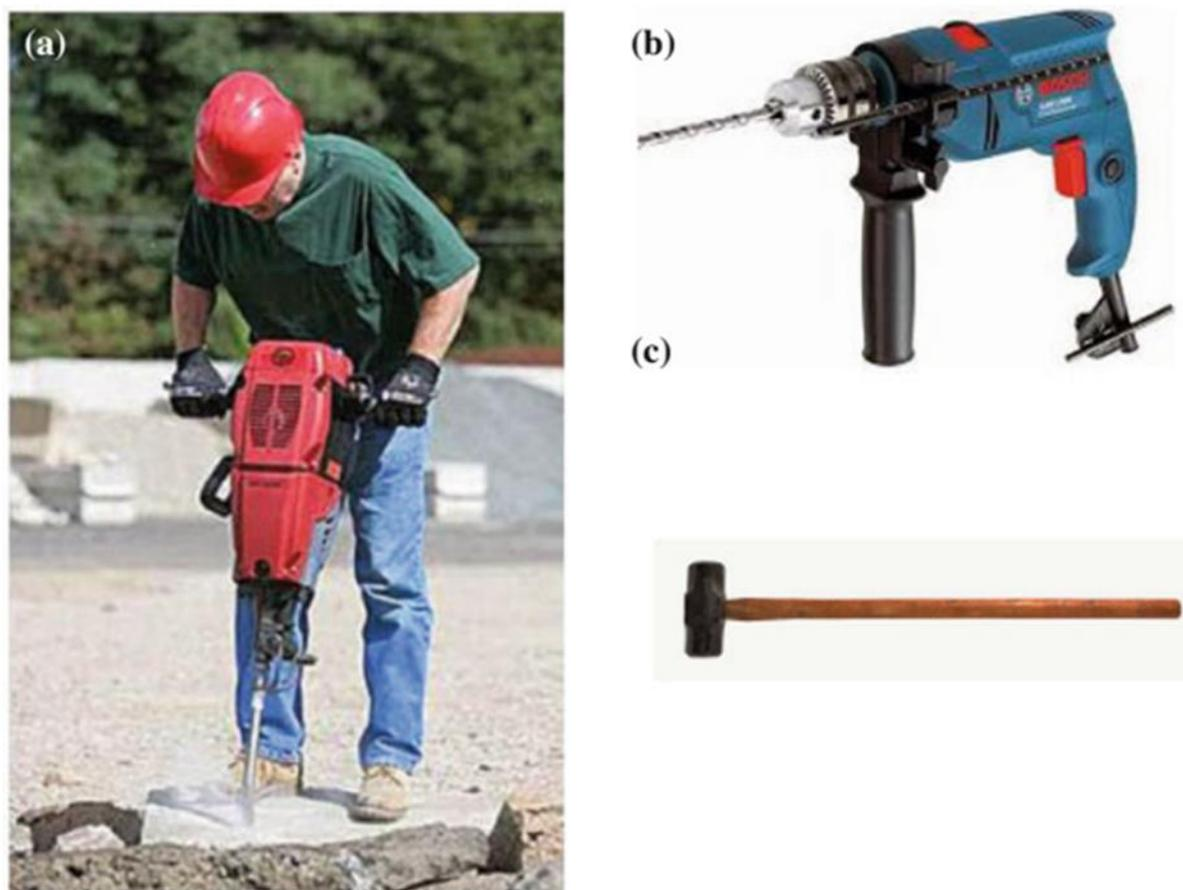
Figure 1.1 : Outils manuels (a) Marteau piqueur (b) Perceuse et (c) Marteau de forgeron [3].
