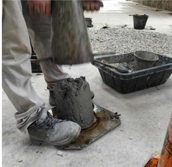
Figure 3.11 : l'essai d'affaissement
