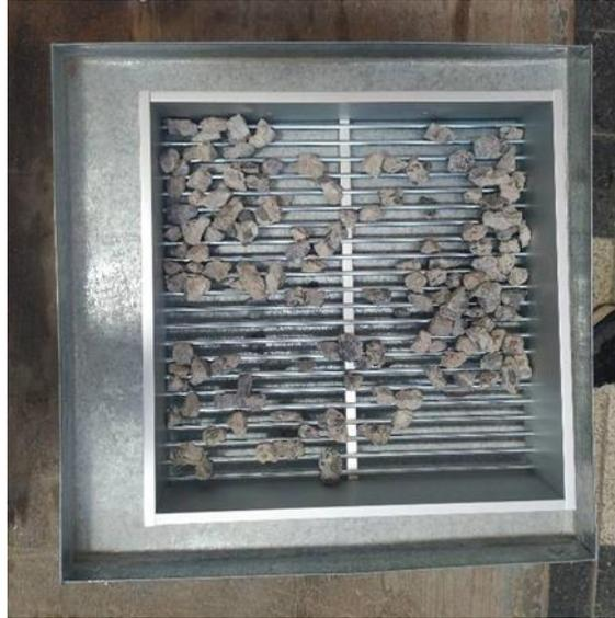
Figure 3.3 : Mesure de coefficient d'aplatissement
