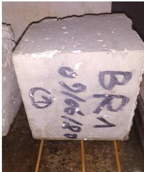
Figure 3.16 : Essai d'absorption capillaire
