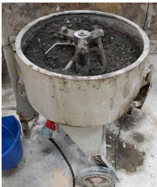
Figure 3.7 : Malaxeur à axe rotatif vertical
