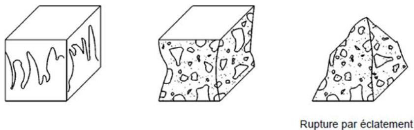
Figure 3.12 : Ruptures correctes d'éprouvettes cubiques [64]
