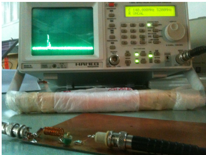
FIGURE 3.12 – filtrage des signaux de la télédiffusions
