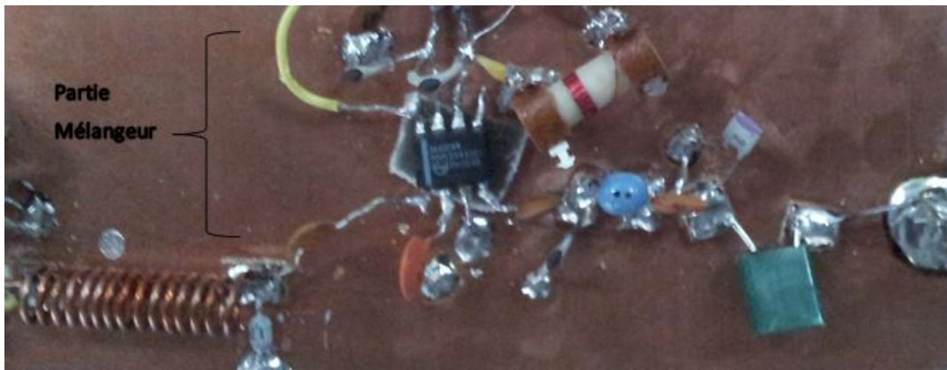
FIGURE 3.20 – Réalisation du mélangeur
