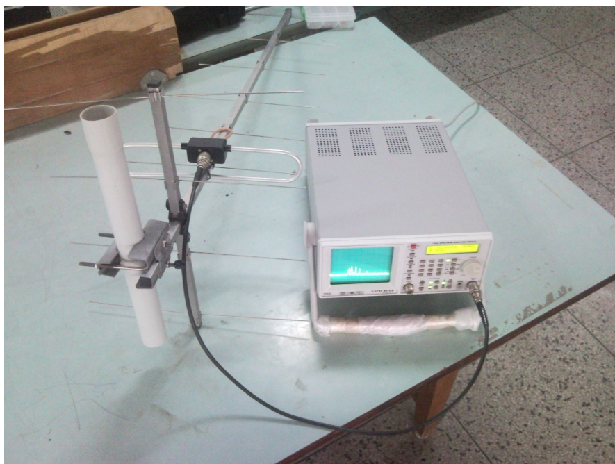
FIGURE 3.7 – Exploration du spectre à l'aide d'une antenne Yagi
