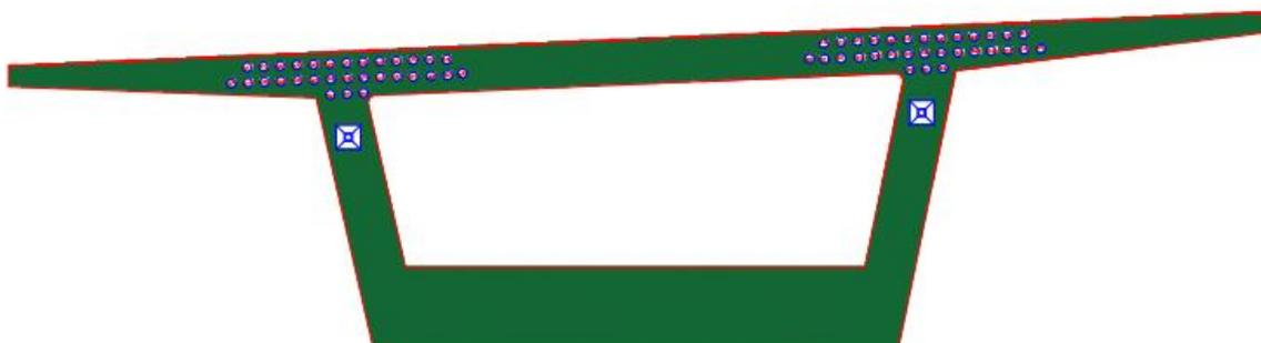
Fig VI-5 Points de passage des câbles de fléau
