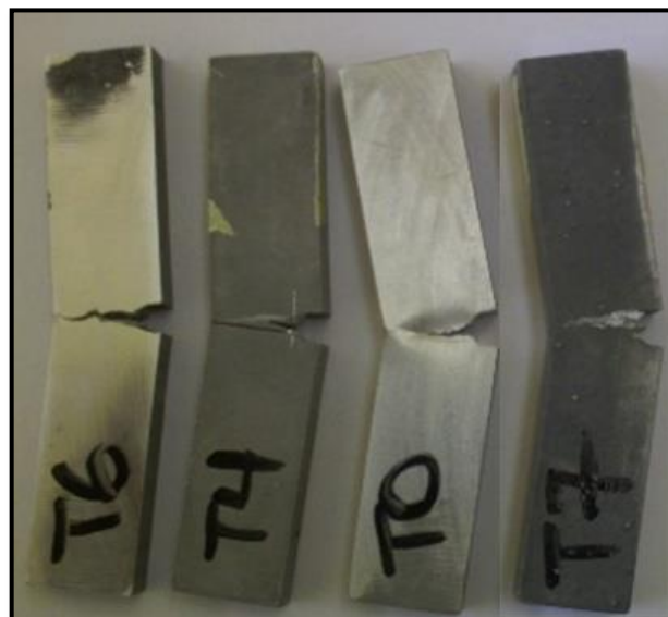
Figure 5-22 : Eprouvettes cassées après essai de flexion pour différents états métallurgiques et après anodisation
