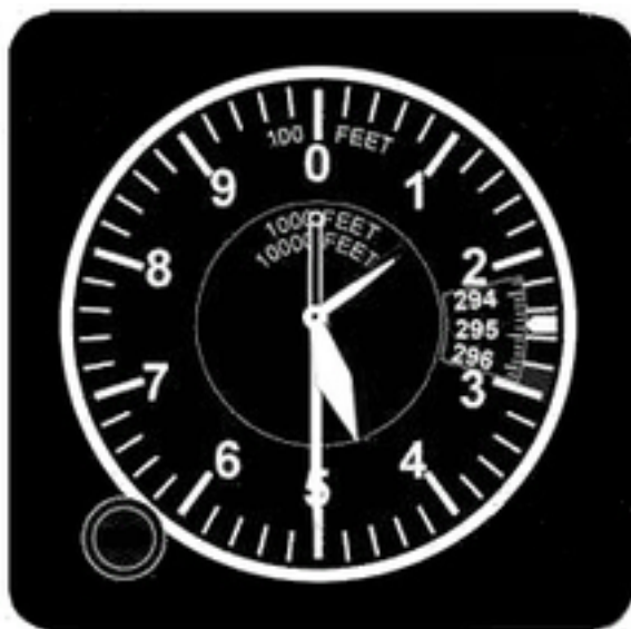
FIGURE 2.8.1: Cadran d'un altimètre de bord Le calage est affiché dans la petite fenêtre à droite (en pouce de mercure) Les trois aiguilles donnent respectivement des dizaines de milliers, des milliers, des centaines de pieds L'altitude affichée est donc de 14 500 pieds
