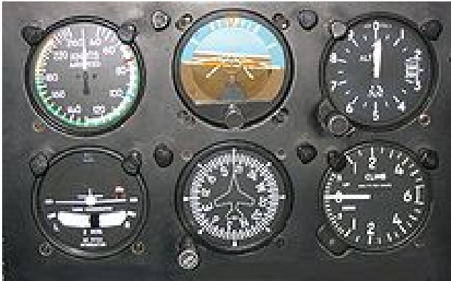
FIGURE 2.7.1: Les 4 instruments de base en T complétés par, en bas à gauche l'indicateur de virage, en bas à droite le variomètre
