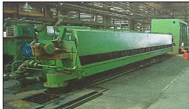
Figure V.3 Machine de tréfilage de fil machine.
