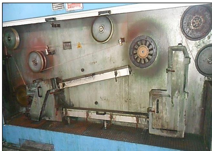
Figure V.15 Four de recuit par l'effet joule.
