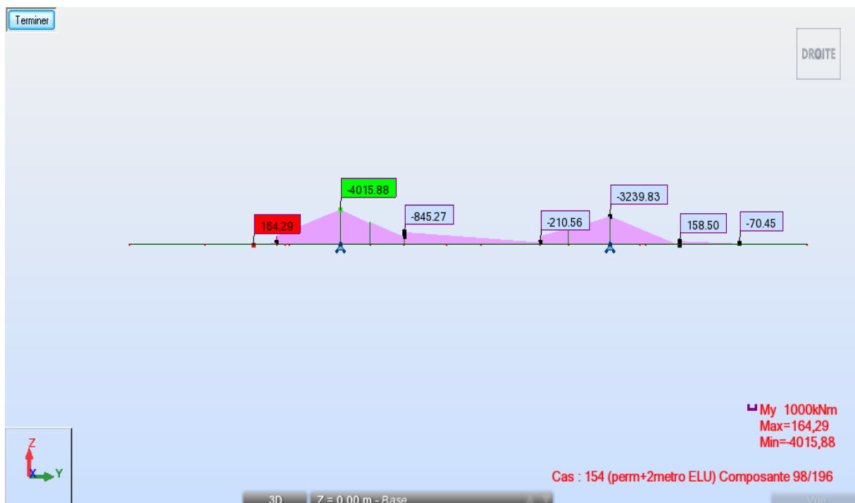
Figure VII.4. Diagramme du moment fléchissant pour l'entretoise à l'ELU.
