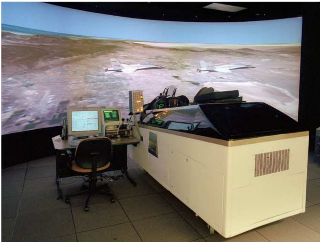
Figure I.4 : Exemple d'un simulateur HIL appliqué à l'avionique
