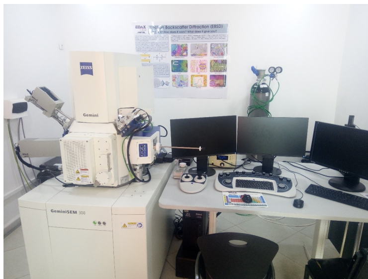
FIGURE 4.7: Microscope électronique à balayage de type ZEISS GeminiSEM 300.
