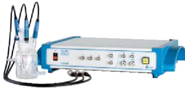
FIGURE 4.6: Dispositif expérimental (la cellule et le Voltalab).
