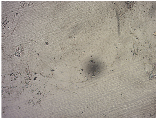
FIGURE 5.19: Observation au microscope optique de l'acier inoxydable 22%Cr duplex (métal d'apport) après l'étude électrochimique à 25°C.50X.
