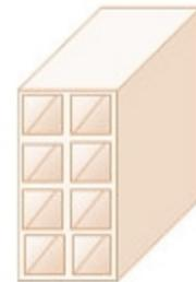
Fig. I.10. Brique creuse
