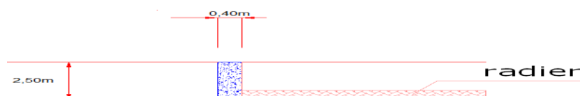
Fig.7.3 Terrassement en grande masse pour drains.
