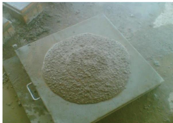
Figure VII.2. Essai d'étalement
