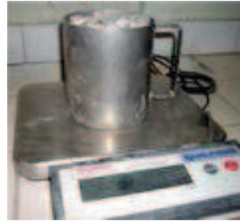
**Photo VI.3** Essai de densité apparente
