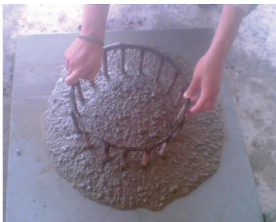
**Figure VII.5.** Essai d'étalement modifié
