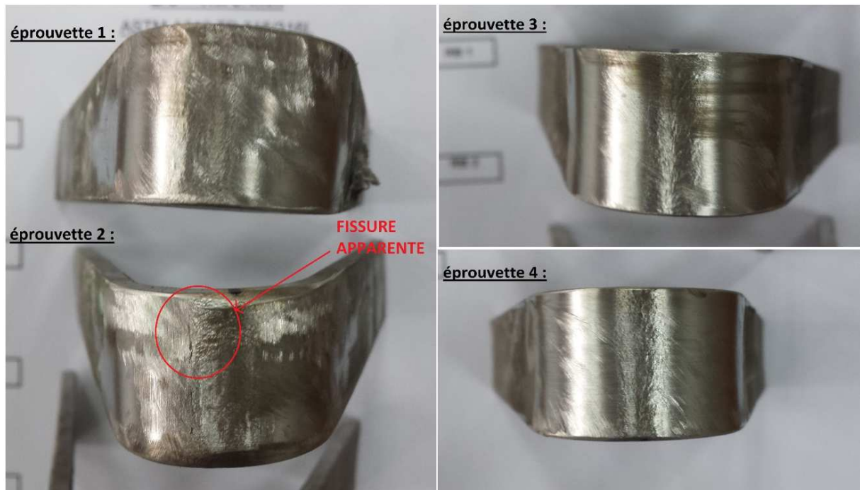
Figure V.5 Eprouvettes d'acier inoxydable 316L après test de pliage.
