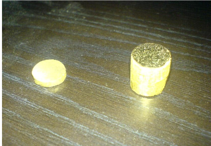
Figure 4.10 Comprimé Cu-Zn à 25%wt fritté à 600°C
