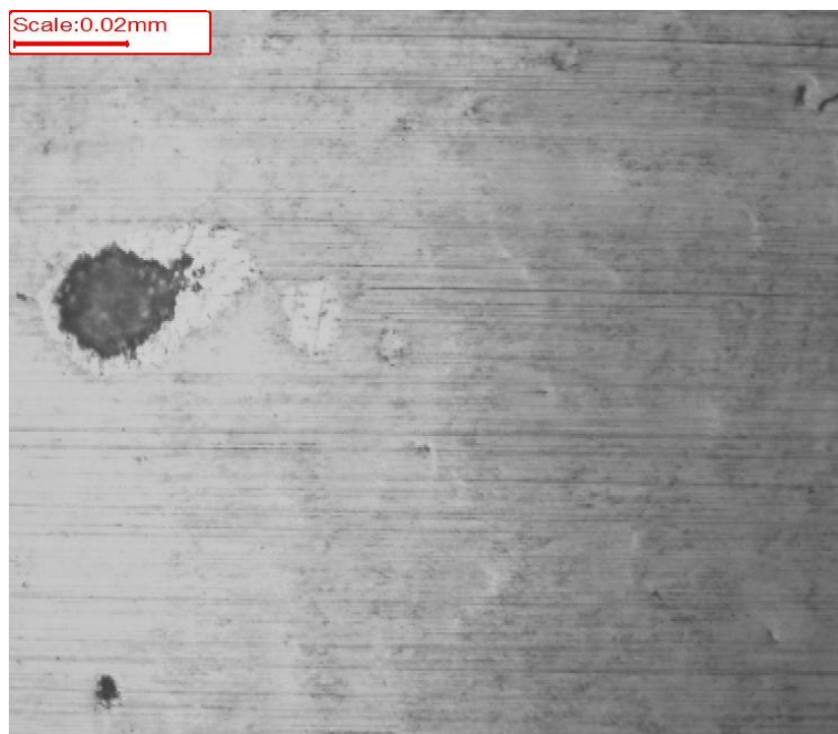
4.33 Observation au microscope Cu-Sn à 0,5%wt Fritté à 220°C pendant 3h, attaqué chimiquement, grossissement x500
