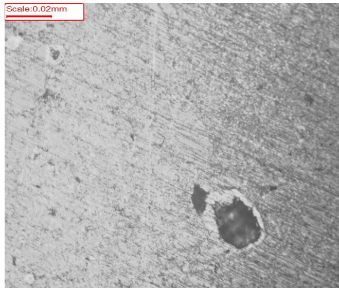
4.32 Observation au microscope Cu-Sn à 0,5%wt Fritté à 220°C pendant 2h, attaqué chimiquement, grossissement x500
