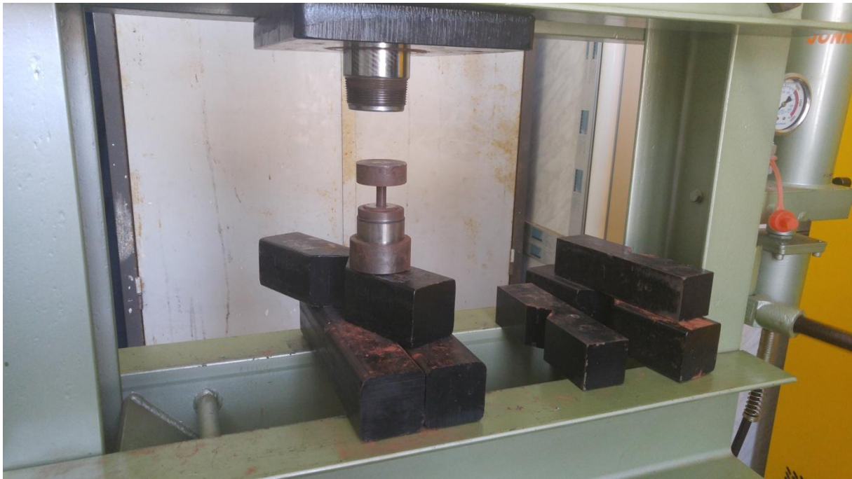
Figure 4.5 L'ensemble matrice-poinçon dans la presse hydraulique
