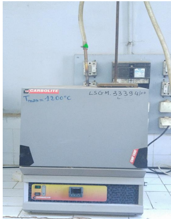
Figure 4.9 Système utilisé pour le frittage
