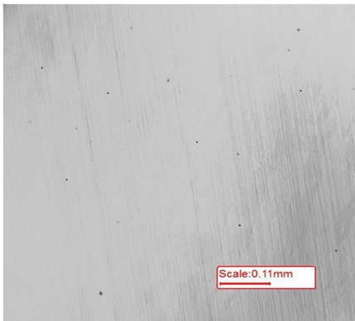
**Figure 5-34** : Piqûres formées dans le ZF de 2209 après polarisation dans une solution de NaCl 0.1 M
