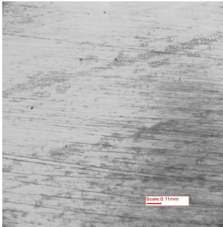
**Figure 5-33** : Piqûres formées dans le ZF de 2209 après polarisation dans une solution de NaCl 0.01 M
