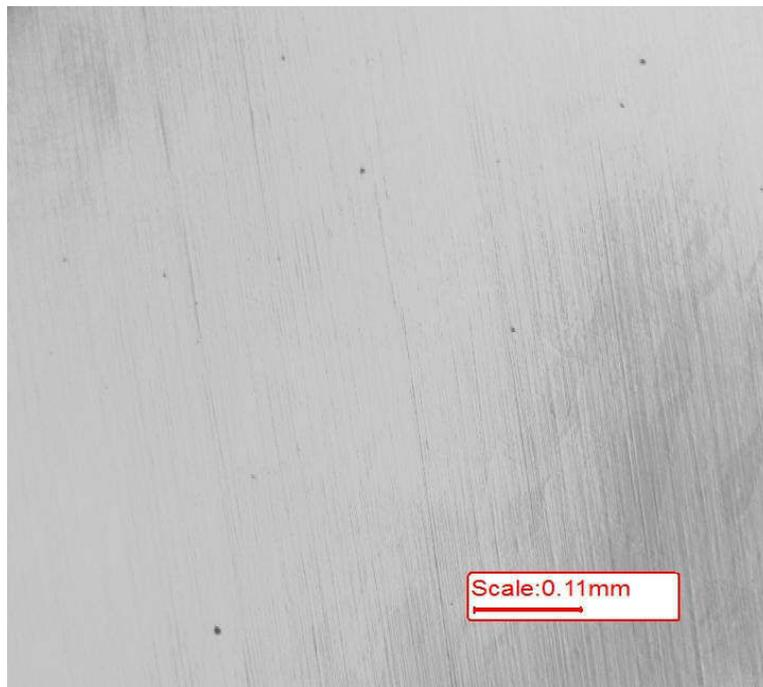
**Figure 5-32** : Piqûres formées dans le ZF de 2209 après polarisation dans une solution de NaCl 0.001 M
