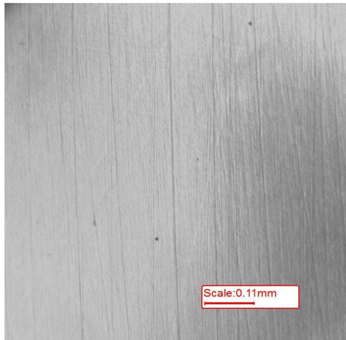
**Figure 5-26** : Piqûres formées dans le ZF de 316l après polarisation dans une solution de NaCl 0.001 M
