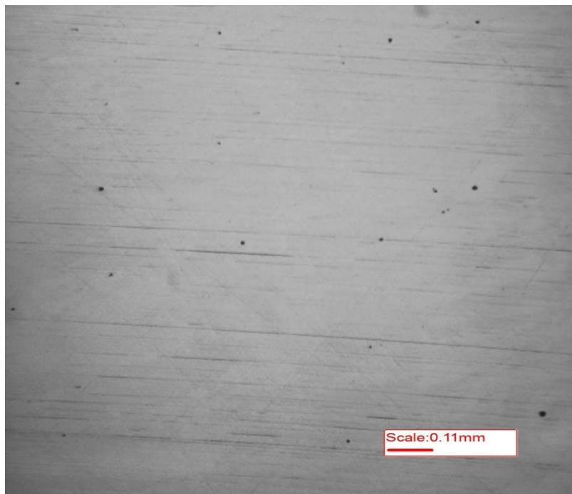
**Figure 5-24** : Piqûres formées dans le MB de 316l après polarisation dans une solution de NaCl 0.01 M
