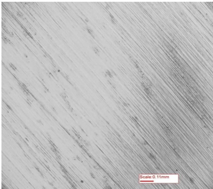
**Figure 5-28** : Piqûres formées dans le ZF de 316l après polarisation dans une solution de NaCl 0.1 M
