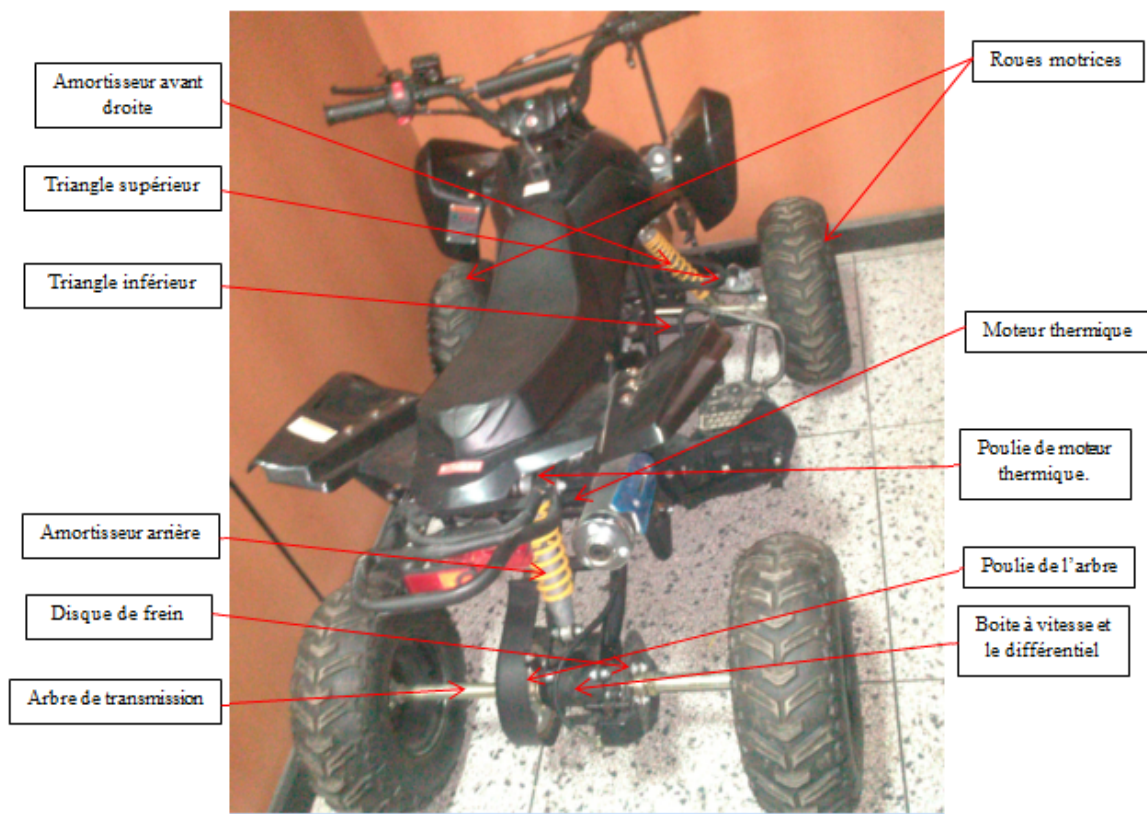
FIGURE II.1 – Structure mécanique du quad conventionnel
