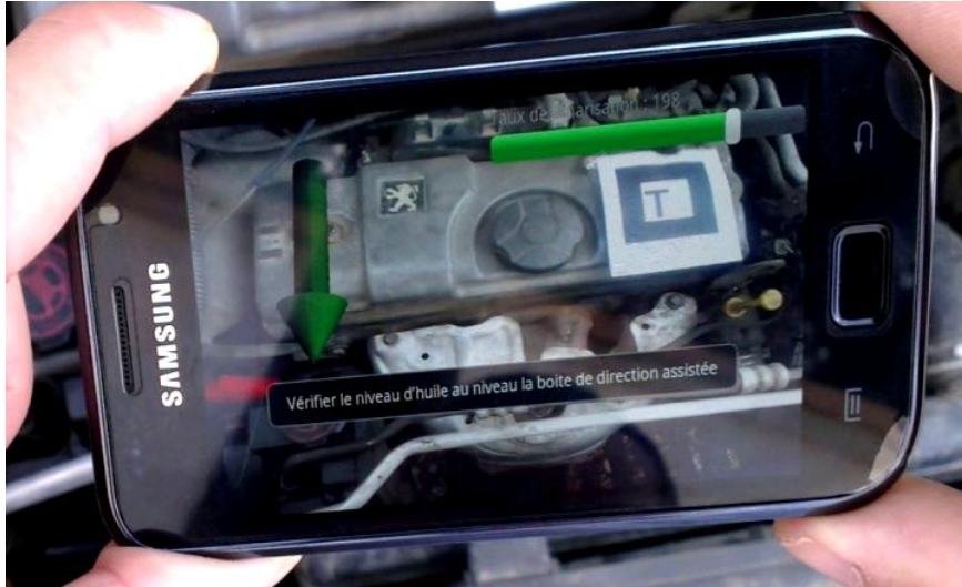
Figure 4.26 Interface interactive sur Samsung Galaxy S1 pour la maintenance du moteur Peugeot 206.
