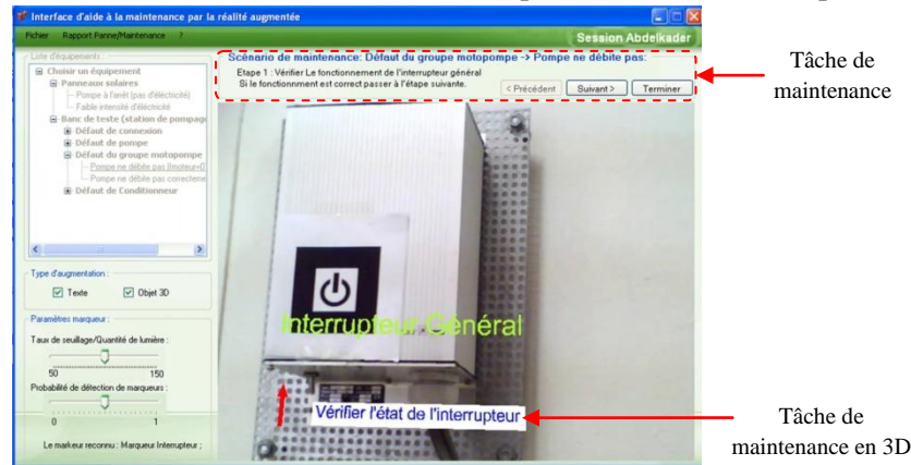
Figure.4.20 Tâche augmentée N°1: "vérifier l'état de l'interrupteur".
