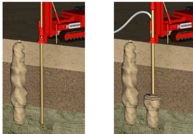
FIGURE 2.5: Amélioration de sol par injection solide.
