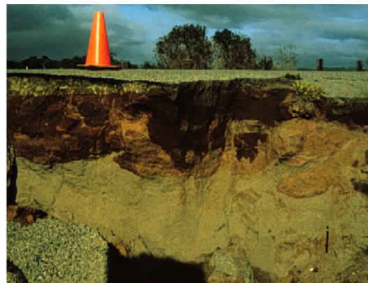
(b) Section transversale des couche sols sous-jacents
