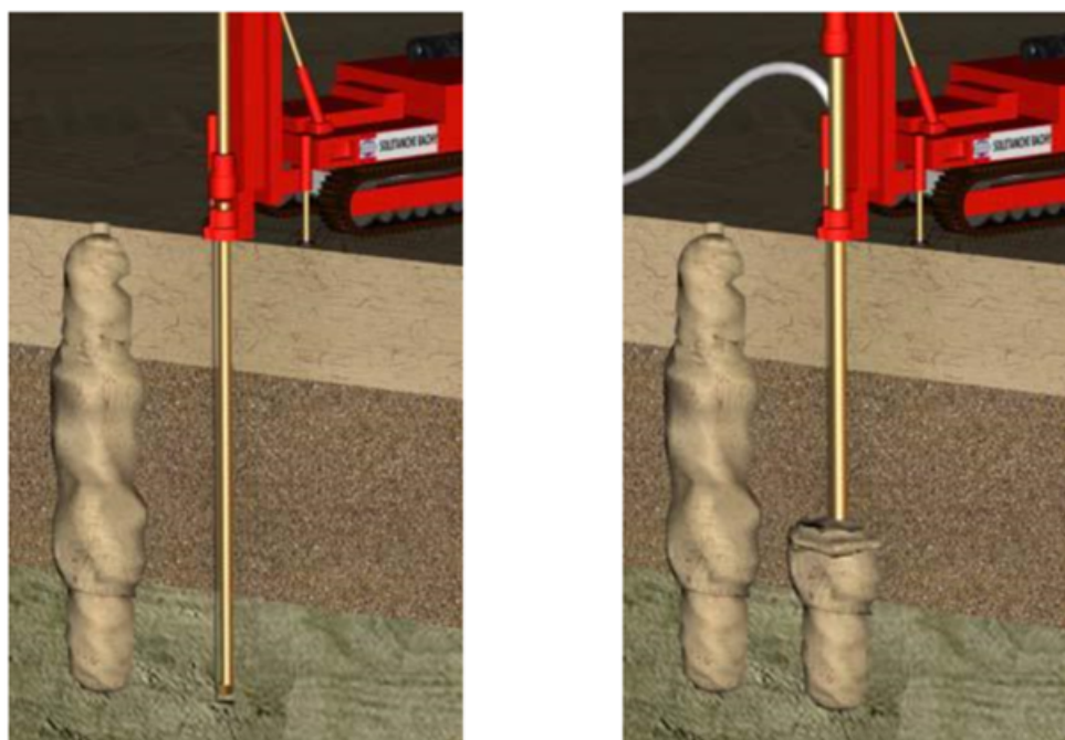
FIGURE 2.12: Amélioration de sol par injection solide.
