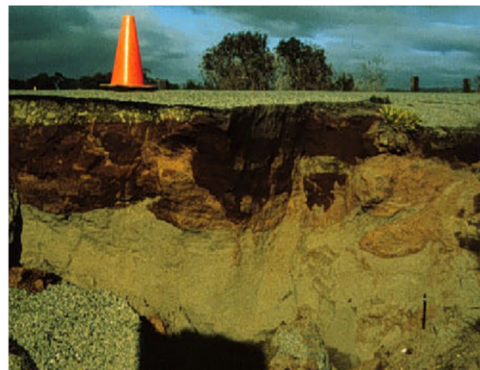
(b) Section transversale des couche sols sous-jacents
