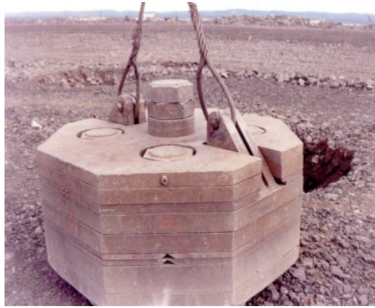
FIGURE 2.4: Exemple d'un pilon.
