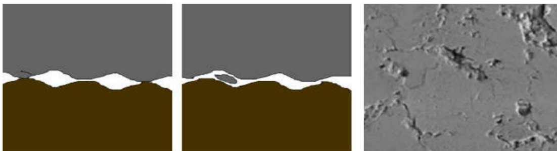
Figure 4.8 Mécanisme d'usure par fatigue [138] Figure 4.9 Etat de surface après une usure par fatigue [135]
