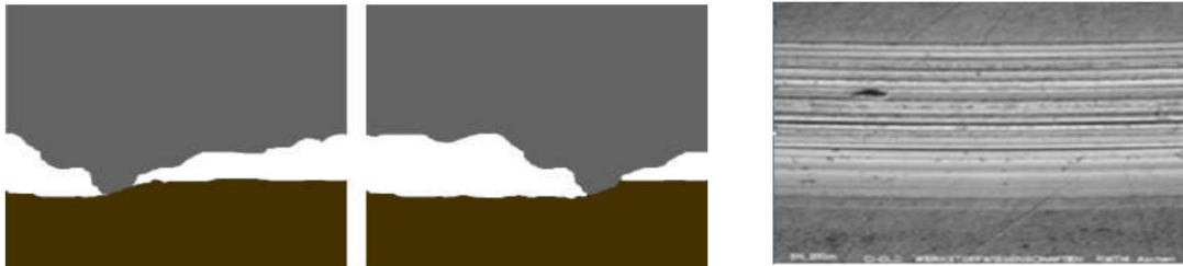
Figure 4.2 Mécanisme d'usure abrasive [134] Figure 4.3 Etat de surface après une usure abrasive [135]
