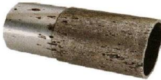
Figure 3.6 Corrosion par piqûres d'un acier inoxydable [89]
