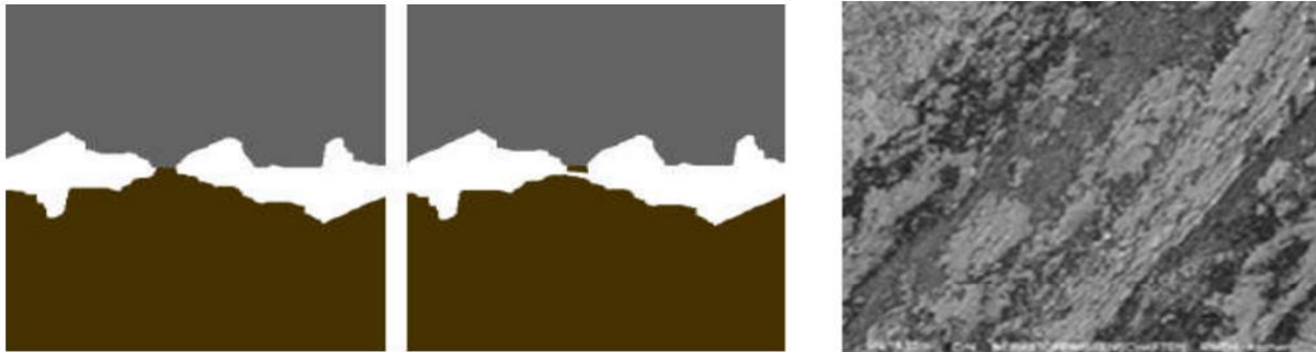
Figure 4.4 Mécanisme d'usure adhésive [136] Figure 4.5 Etat de surface après une usure adhésive [135]
