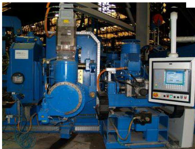
Figure IV. 2 : Machine ATIS pour le soudage SAW H.
