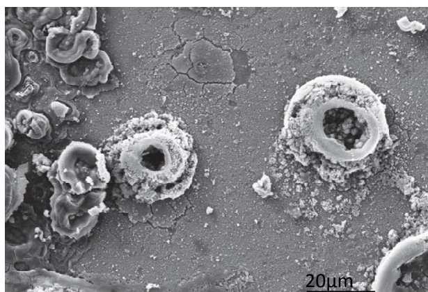
Figure V.28 : Image MEB de piqûres sur l'acier X52 après polarisation dans une solution extraite du sol, [37].
