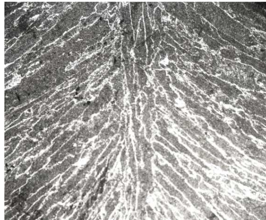
Figure II.9 : orientation des grains lors du refroidissement.
