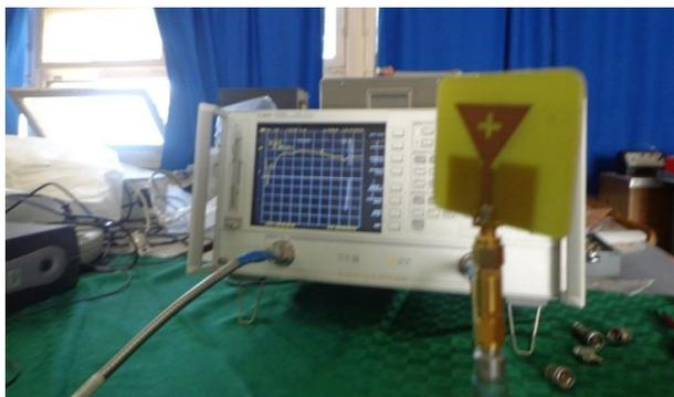
Fig. 3.67 Banc de mesure du coefficient  $S_{11}$  de l'antenne proposée.
