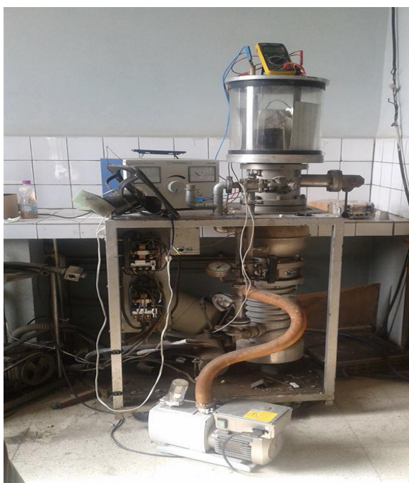
Fig III. 5 : Schéma de montage du four sous vide.
