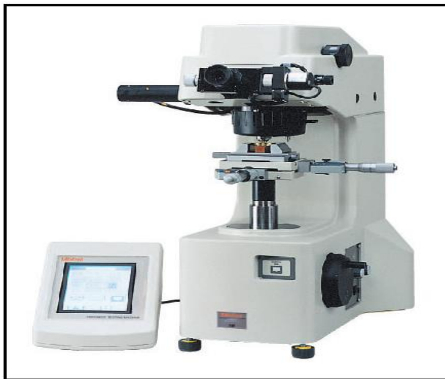
Fig III. 10 Machine de microdureté utilisée dans notre étude.
