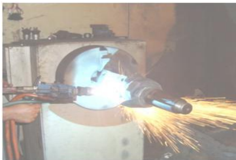
Fig III. 3 : Pistolet de projection à arc électrique « Arc spray 234 »
