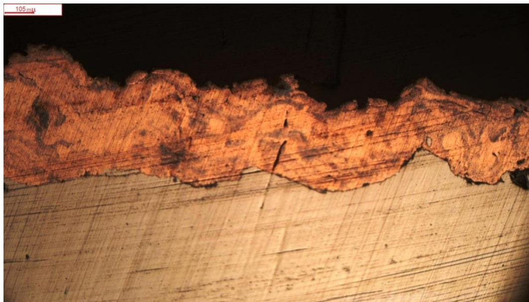
Fig IV. 7 Micrographie de l'interface recuit à 650°C pendant 5 heures sous vide.
