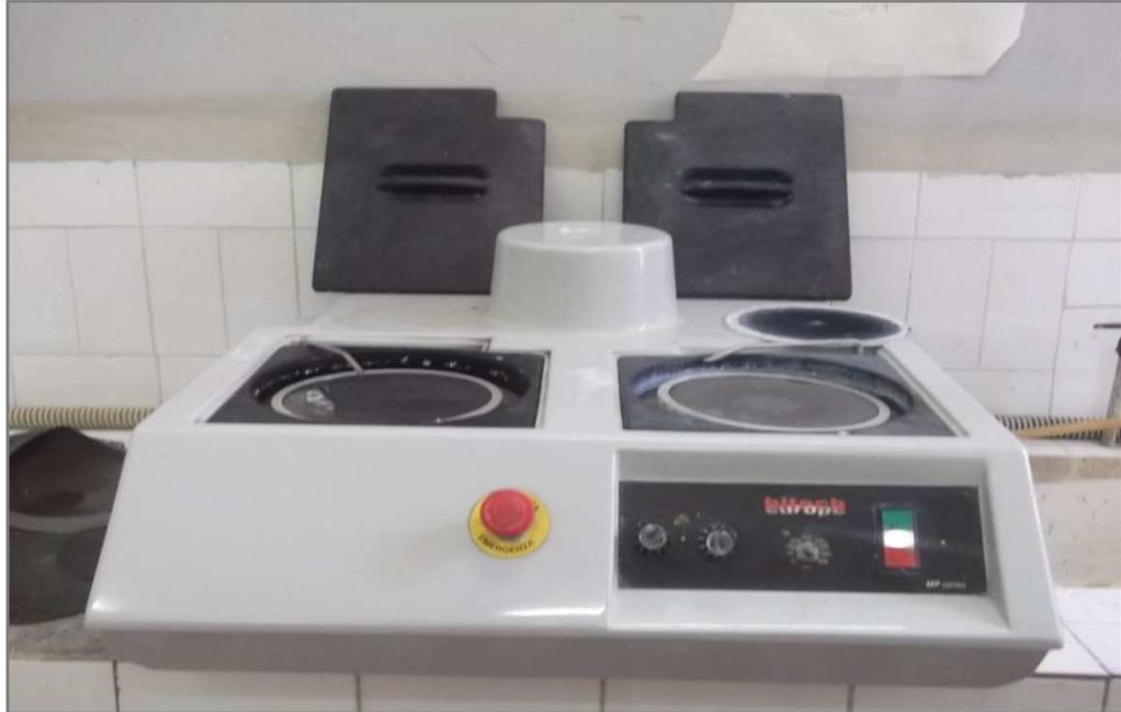
**Figure IV.1** Polisseuse mécanique de type hitecheurope, à vitesse maximum de 600 tr/min. (ENP, laboratoire de métallurgie).
