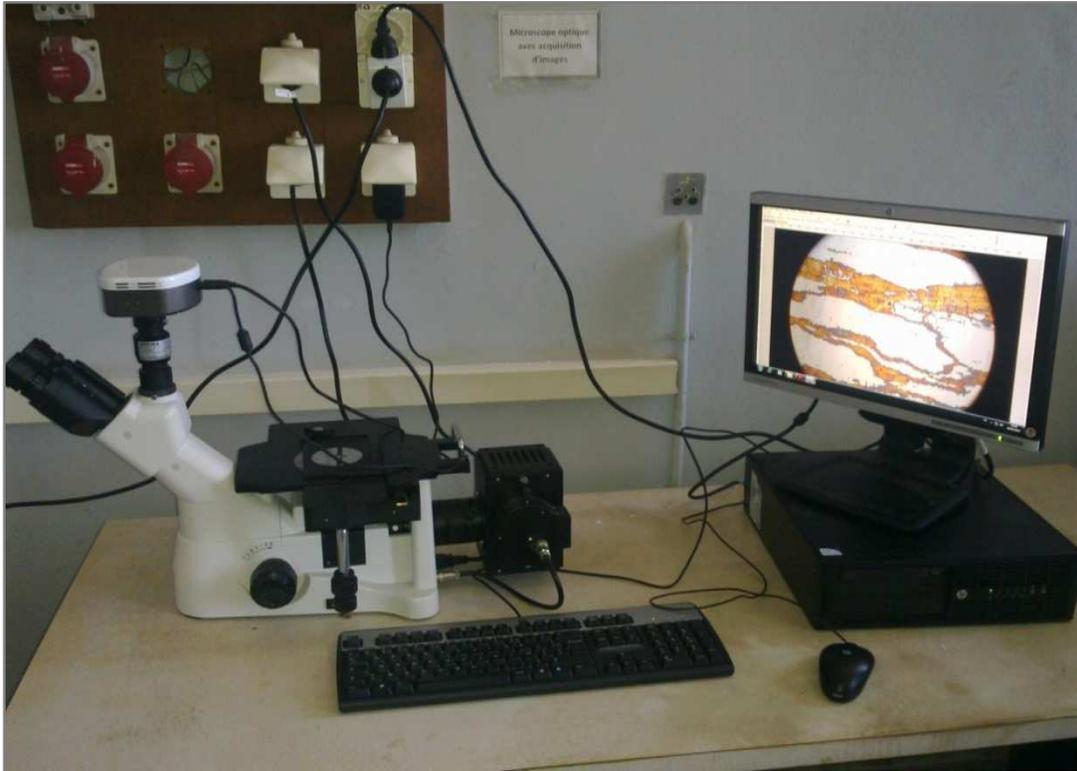
**Figure IV.2** Microscope optique de type OPTIKA. (ENP, laboratoire de métallurgie).
