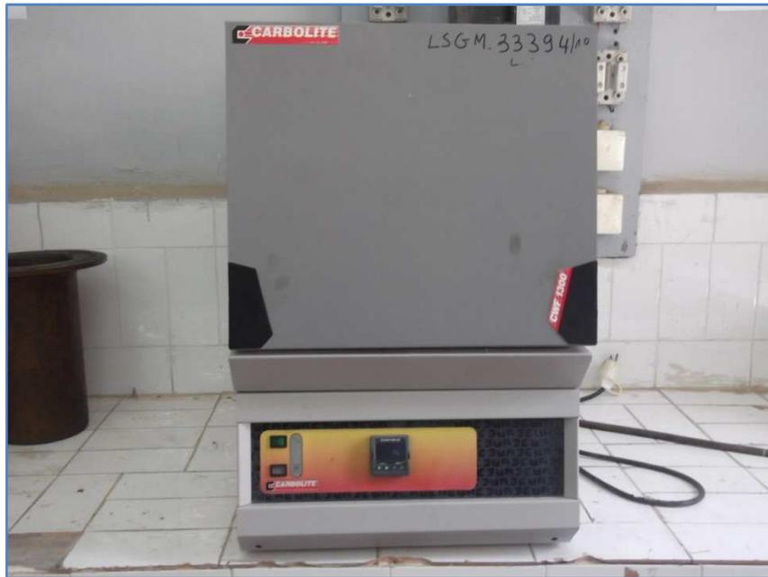
**Figure IV.8** Four à résistance électrique CARBOLITE CWF 1300(ENP, laboratoire de métallurgie.
