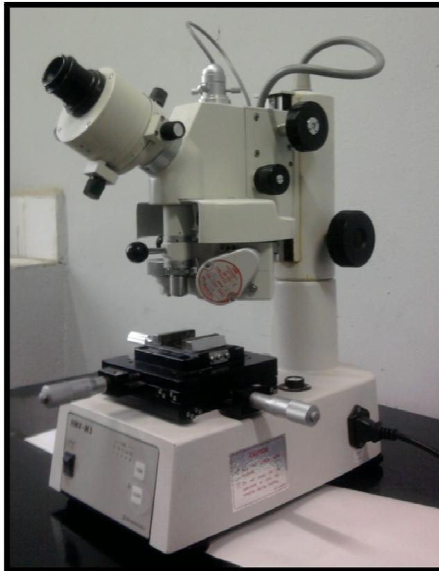
**Figure IV.6**Microduromètre de type SHIMADZU HMV-M3.
