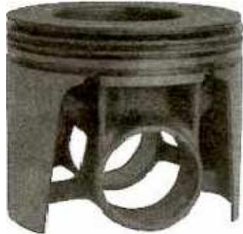
**Figure I.2.** Piston en fonte [3].
